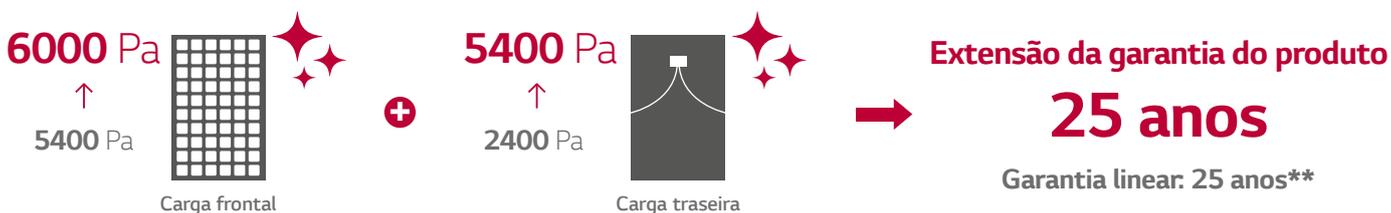
\* O módulo está totalmente em conformidade com os novos procedimentos de teste com base nas normas IEC 61215-2: 2016 que confirmaram uma carga frontal de 5400 Pa e uma carga traseira de 4000 Pa. A LG realizou ensaios internos para confirmar a carga frontal de 6000 Pa e a carga lateral traseira de 5400 Pa também com base nas novas normas IEC 61215-2: 2016. Estão em curso mais testes. A menos que estes testes tenham resultados diferentes, a LG confirma 6000 Pa/5400 Pa.
